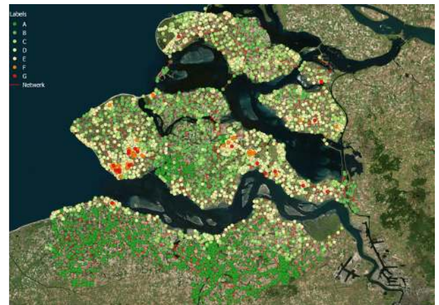
FIG. 1 Voorlopige Risicolabels van alle verdeel- en schakelstations op middenspannings- en hoofdspanningsniveau in Zeeland. De puntentelling achter de labels moet nog definitief worden gemaakt
