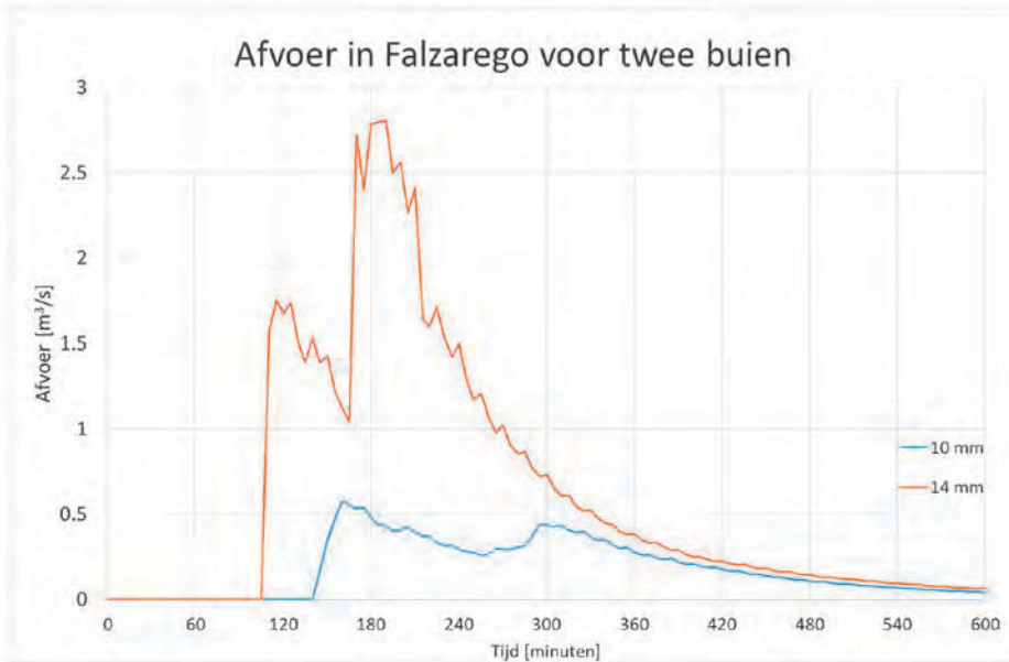
Afbeelding 4: Gesimuleerd verloop van de afvoer in de tijd na een bui van 10 en 14 mm in 60 minuten. Helaas waren afvoermetingen niet beschikbaar.
